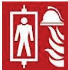
Bild 1. Kennzeichnung „Feuerwehraufzug“ (nach DIN 81-72)
