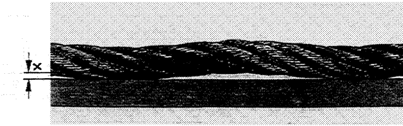
Bild 1. Drahtseil mit korkenzieherartiger Verformung
