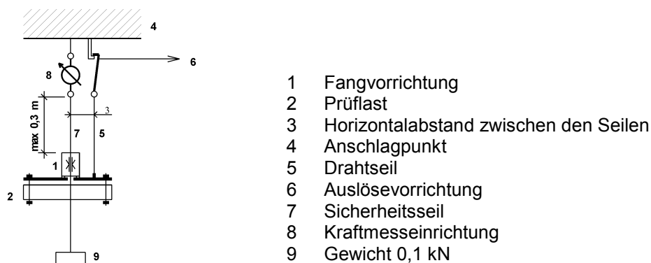
Bild B.1 — Typischer Prüfstand für eine Fangvorrichtung
