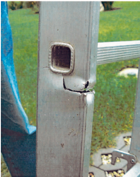
Bild 51: Stark beschädigte Leiter
