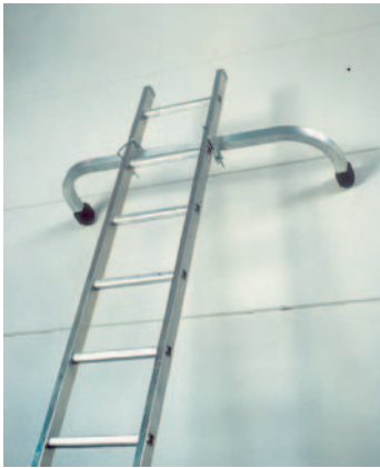
Bild 28: Wandabstützung (Verbreiterung des Leiterkopfes)
