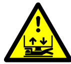
Bild 4 — Warnzeichen „Gefahr - Verringerter unterer Schutzraum“
