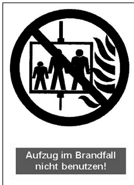
Bild 4. Ausführung roter Kreis in RAL 3000, schwarzes Fahrkorbsymbol, Schrift weiß, Hintergrund rot nach RAL 3000
