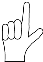
Beginn der Seilwicklung für rechtsgängiges Seil am rechten Flansch
