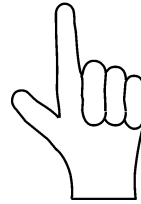
Beginn der Seilwicklung für linksgängiges Seil am linken Flansch
