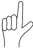
Beginn der Seilwicklung für rechtsgängiges Seil am rechten Flansch
